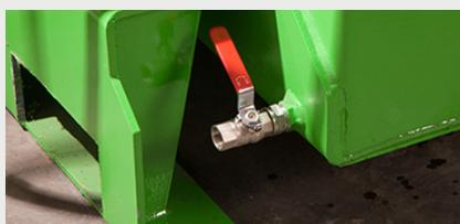
Réservoir de rétention des liquides de 40 litres avec robinet d'évacuation
