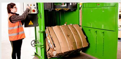
Le haut ratio de compactage permet de créer une balle optimale de 250 kg
