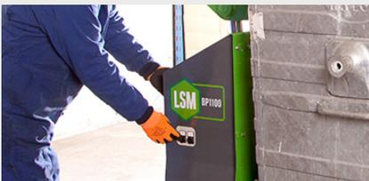
Los controles manejables con las dos manos ofrecen una mayor seguridad y un sistema único de contrapalancas protege el fondo del contenedor.
