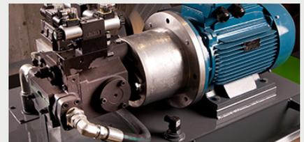
Motor de 15 kW para que tanto la compactación de las balas como el consumo de energía sean eficientes
