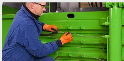
Sistema de atado fácil con 4 flejes que asegura que la bala permanezca compactada
