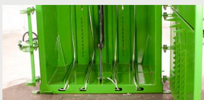
Eyector integrado para retirar fácilmente las balas
