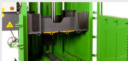
Una increíble fuerza de prensado de 50 toneladas y un cilindro de carrera larga permiten alcanzar la máxima compactación y producir balas de 400 – 500 kg.
