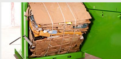
Eyector integrado para retirar fácilmente las balas
