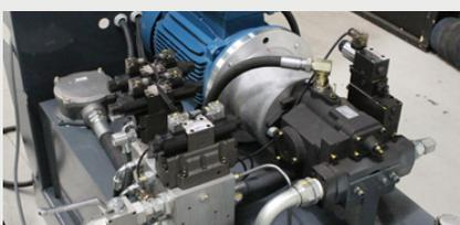
Bloque de alimentación de 15 kW y cilindros de carrera larga para una compactación óptima
