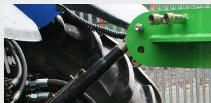
Fonctionne sur un vérin à simple effet d'un tracteur ou d'un chariot élévateur
