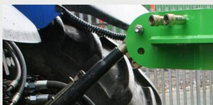
Funciona con un distribuidor de efecto simple de un tractor o una carretilla elevadora.
