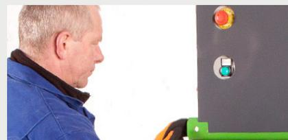
Controles de bajo voltaje para el operario y parada de emergencia para una mayor seguridad, así como ciclos automático y manual opcionales
